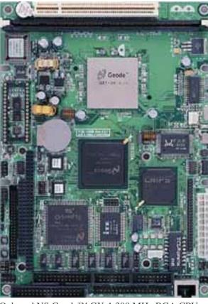
Onboard NS Geode™ GX-1 300 MHz BGA CPU
